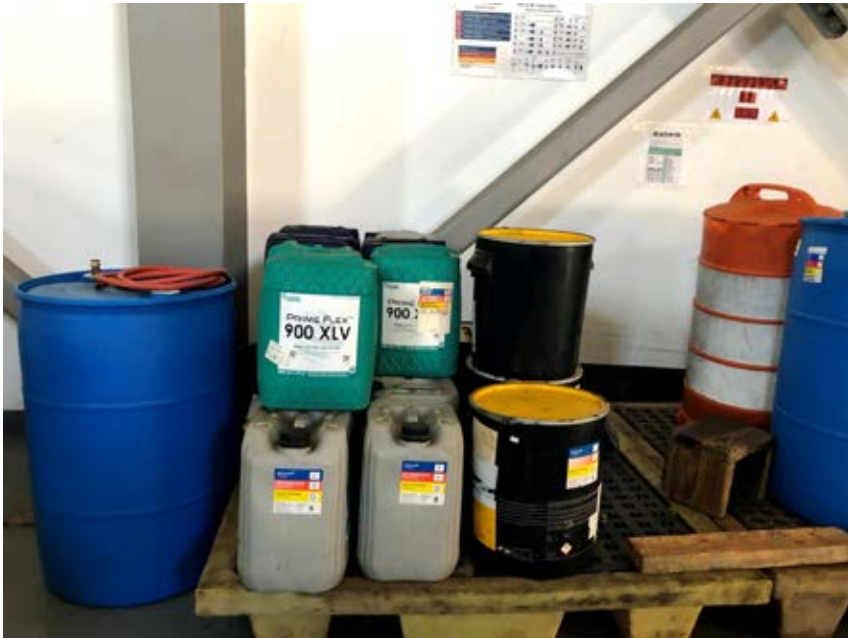
Materiales peligrosos almacenados con contención secundaria y etiquetado correcto
