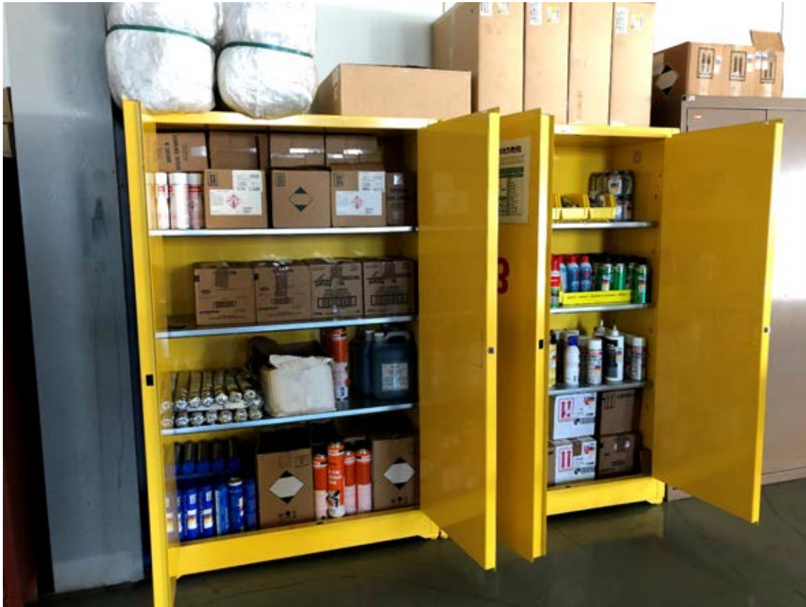
Almacenamiento de materiales peligrosos bajo llave
