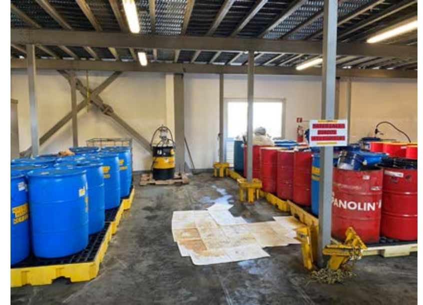
Derrame de sustancia peligrosa atendido con pads absorbentes
